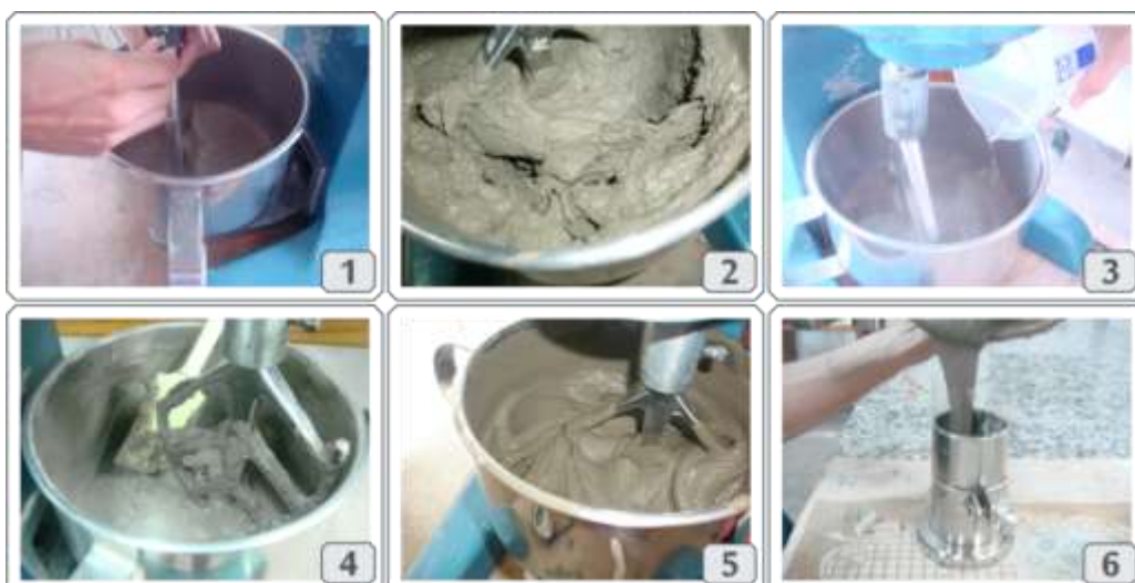
FIGURA 4 - Processo de mistura da pasta de cimento: 1) Fixação das pás para início da mistura; 2) Mistura até o 2º minuto; 3) Adição do restante da água no 3º minuto e mistura no 4º minuto; 4) Limpeza da cuba no 5º minuto; 5) Mistura final no 7º minuto; 6) Moldagem dos corpos-de-prova.
