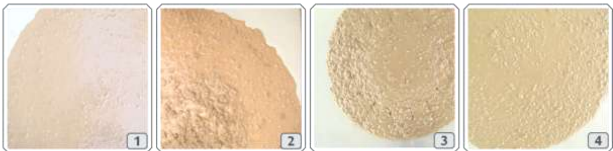
FIGURA 7 - Espalhamentos do CAA pesquisado: 1) Concreto com elevada exsudação na parte externa do espalhamento; 2) Concreto com exsudação e segregação, no centro e ao final do espalhamento; 3) Concreto com baixa fluidez e pouca deformabilidade e 4) Concreto com fluidez adequada.
