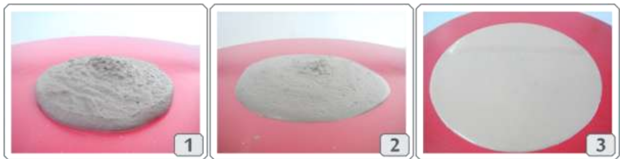
FIGURA 5 - Ensaio de Kantro para diferentes argamassas: 1) Elevado percentual de agregado miúdo, resultando em baixa deformabilidade; 2) Baixa dosagem de superplastificante, resultando em baixa fluidez; 3) Boa deformabilidade dado o percentual apropriado de agregado miúdo.
