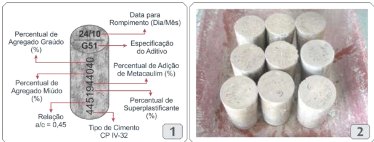
FIGURA 8 - Identificação dos corpos-de-prova de CAA: a) Codificação adotada para melhor identificação; b) Corpos-de-prova devidamente identificados prontos para início da cura.
