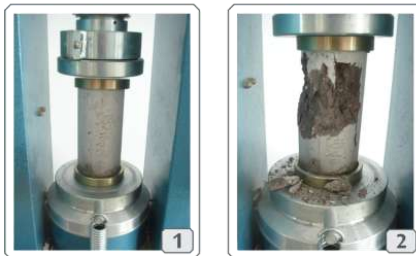
FIGURA 9 - Ensaio de resistência mecânica à compressão em prensa manual de 100 toneladas: 1) Corpos-de-prova durante o rompimento; 2) Corpos-de-prova já rompidos.
