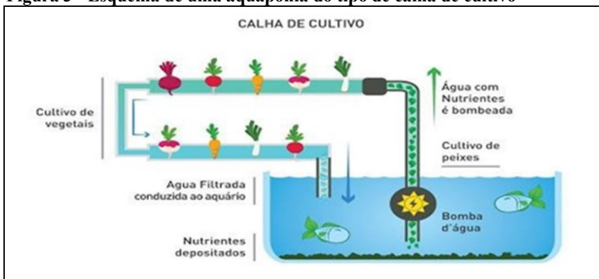
Figura 3 - Esquema de uma aquaponia do tipo calha de cultivo
