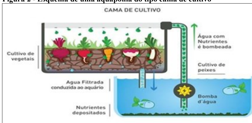
Figura 2 - Esquema de uma aquaponia do tipo cama de cultivo
