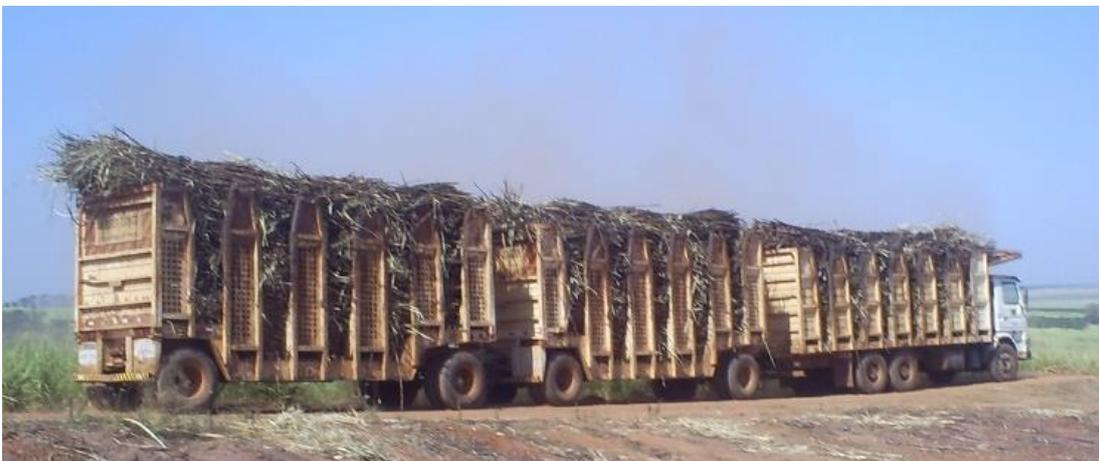
Normalmente ao chegar à lavoura para o carregamento, as carretas são desengatadas e conduzidas por tratores-reboque até as carregadeiras, que depois de carregadas são devolvidas ao local de engate onde são novamente engatadas ao caminhão, conforme fluxograma a seguir (Figura 5).
