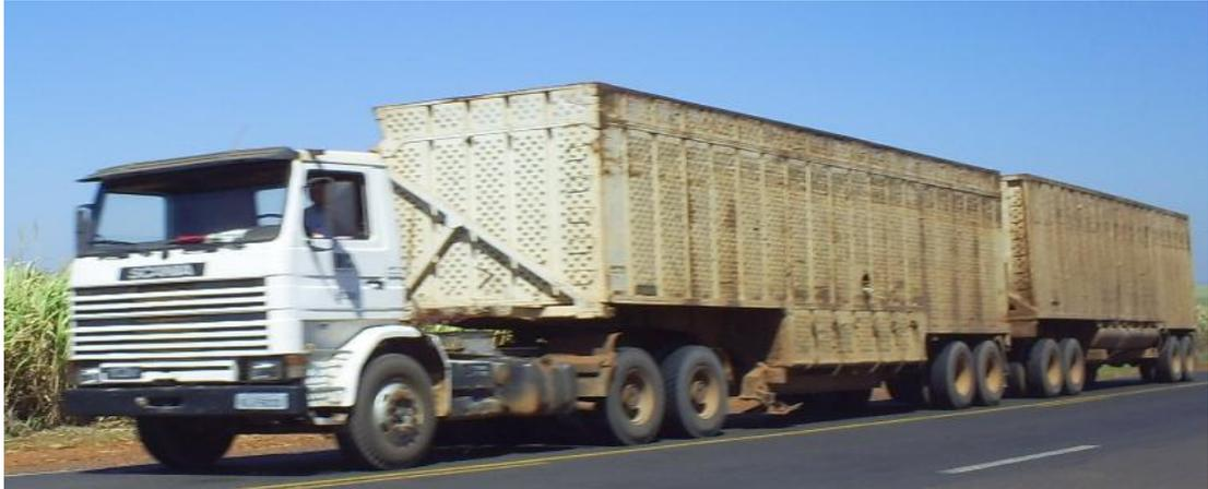
A maior vantagem do rodotrem é relativa à melhor capacidade de carga e a versatilidade de operação do sistema “bate e volta” (Figura 3), que maximiza o uso do cavalo mecânico (SILVA, 2008). No entanto, o rodotrem, associado ao sistema “bate e volta”, que consiste em se ter equipamentos reserva na frente de colheita e/ou na indústria, para reduzir o tempo de carregamento e descarregamento da carga, configura-se como uma opção tecnicamente mais eficiente e segura (CHIARINELLI, 2008).
