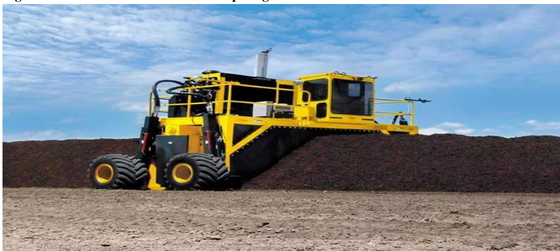
Figura 5 - Misturador industrial de compostagem
