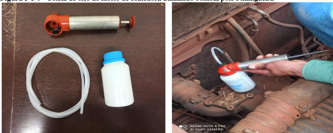
Figura 3 e 4 - Coleta de óleo de motor de colhedora utilizando bomba, pote e mangueira
