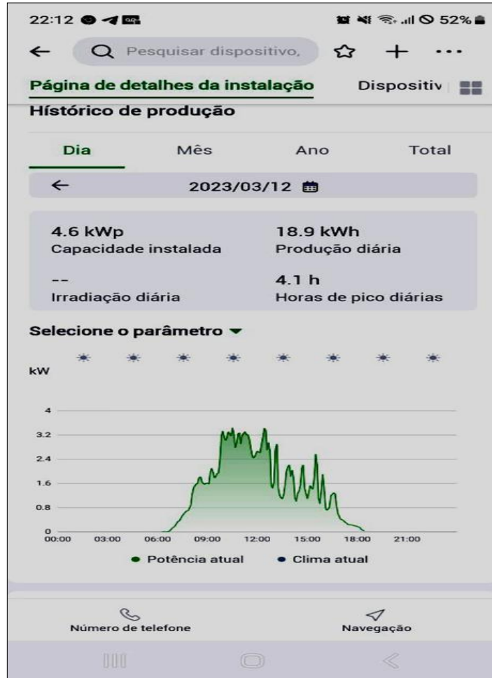
Figura 1 – Monitorização, por aplicativo “Intelbras Solar”, do desempenho do sistema fotovoltaico em uma residência no município de Pontal (SP)
