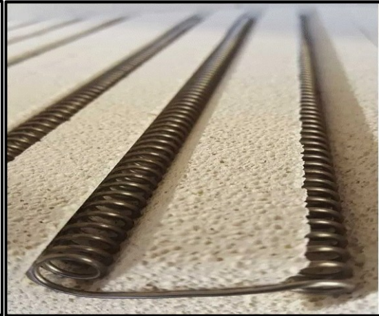
Figura 4-Resistncia- Fio de Níquel-Cromo (NiCr 80/20)
