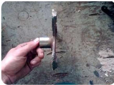
**Figura 2.** Flange da roda após a Competição BAJA SAE Brasil 2010.
