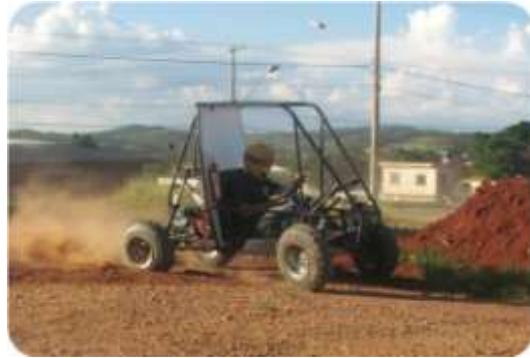
**Figura 1.** Solitação da roda traseira na realização de uma curva.
