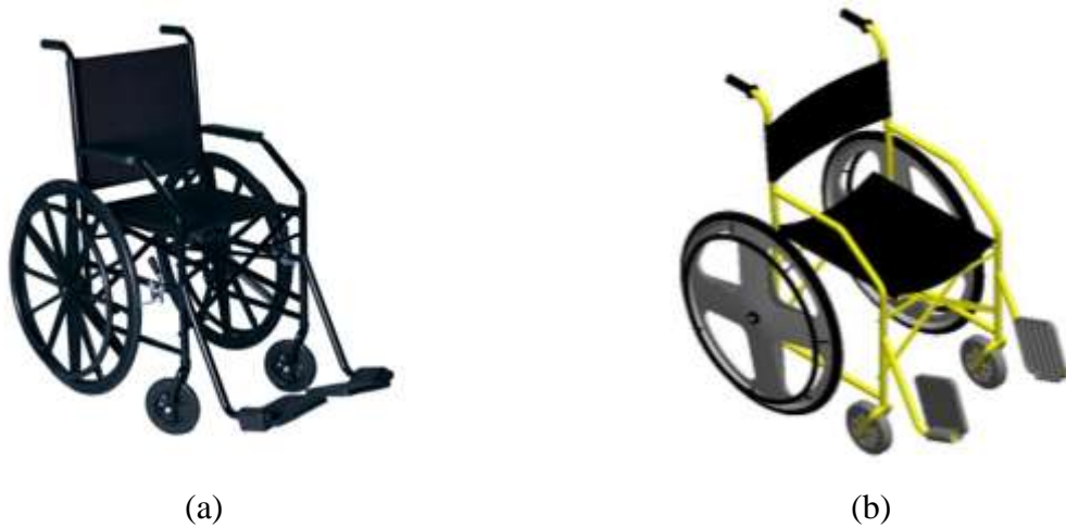
Figura 1. (a) Cadeira de referência para o modelo, (b) Modelo CAD gerado em 3D.
