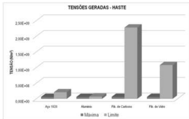
Figura 11. Gráfico comparativo das tensões geradas no componente haste.
