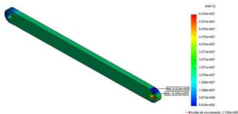
Figura 10. Simulação de tensão no componente haste para aço 1020.
