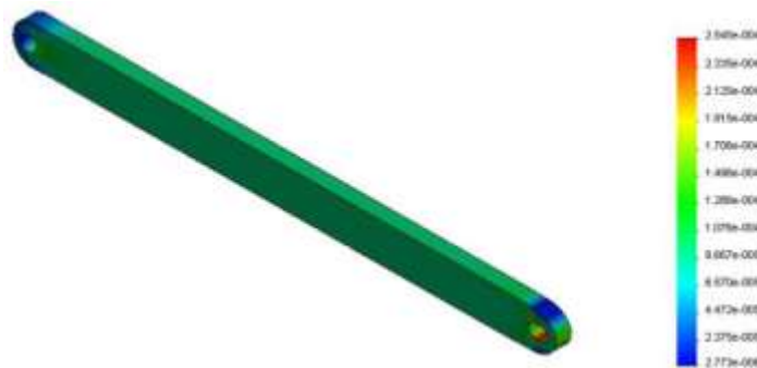
Figura 14. Deformação do componente haste para aço 1020.
