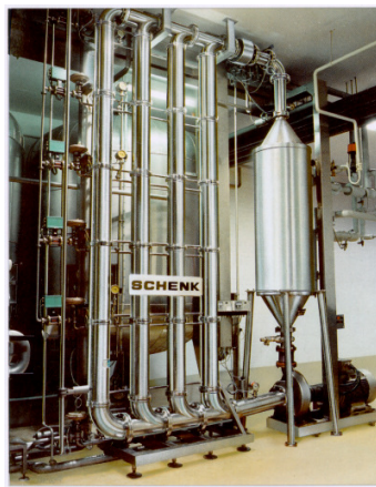
Figura 4. Planta industrial para processamento de cerveja – área de filtração de 72 m 2 (Dortmunder Actien-Brauerei) (SCHENK FILTERSYSTEME, 1995).
