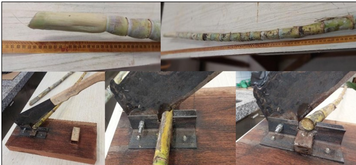
Figura 2 – Sistema para medição e separação dos entrenós de acordo com a isoporização do tecido meristemático
